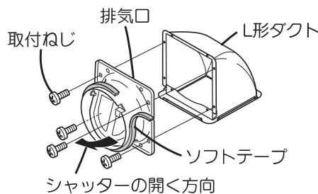
別売のL形ダクトを使用しないで、排気口に直接ダクトを接続して後方排気する場合は、シャッターの開く向きに注意して排気口を取り付けてください。
